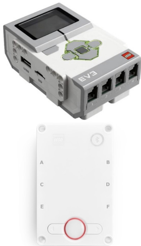
Figura IV.6.1 - Blocos programáveis do kit LEGO® Mindstorms EV3 (esq.) e LEGO® Education SPIKE™ Prime (dir.). Adaptado de: lego.com.
