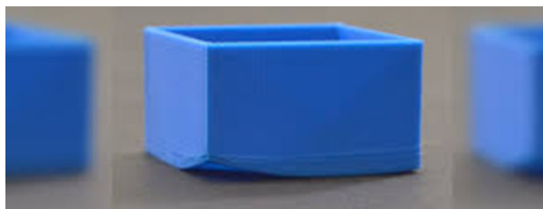
Figura IV.2.18 - Warping (empenamento). Fonte: Tech CD notícias (2021)
