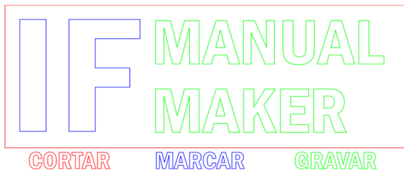
Figura IV.3.6 - Relação das cores dos contornos e os procedimentos de corte, marcação e gravação. Fonte: Acervo de professor colaborador.
