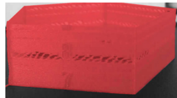
Figura IV.2.20 - Sub-extrusão. Fonte: Prototipando (2020)
