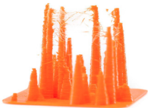
Figura IV.2.21 - Stringing. Fonte: Combtech
