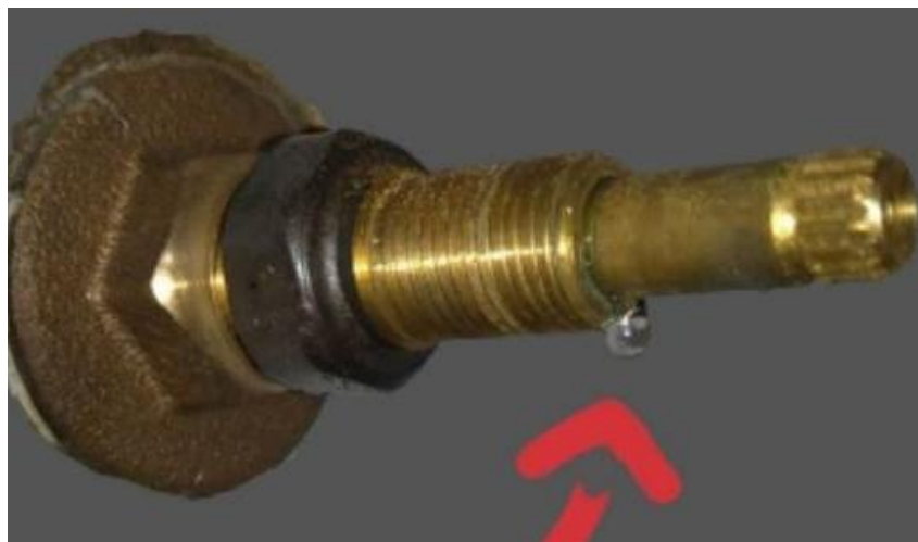
Imagem ilustrativa: registro de pressão/gaveta com vazamento.
